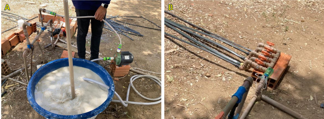
Figura 6. Sistema de fertirrigação por bomba injetora (A) e cabeçal de controle da irrigação para os diferentes tratamentos de turno de rega (B).
