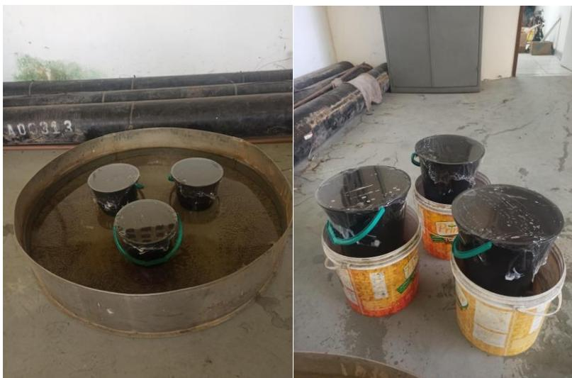
Figura 8. Detalhes da determinação da umidade a capacidade de vaso.
